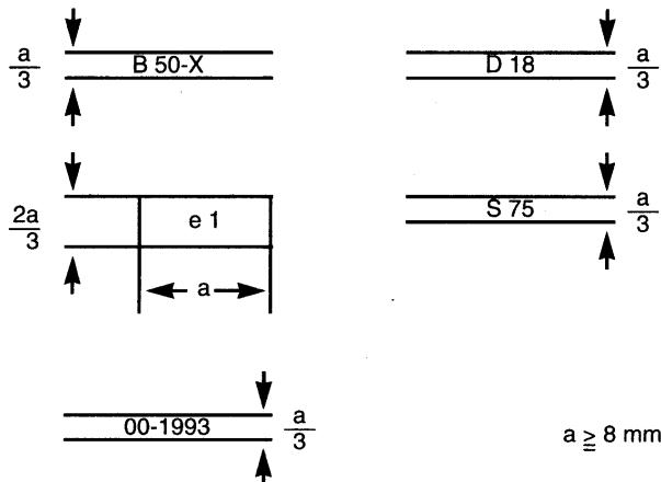
Η διάταξη ζεύξης με τη σήμανση έγκρισης EOK, που φαίνεται ανωτέρω, είναι ένας σφαιρικός σύνδεσμος, κατηγορίας B50-X, με τιμή του D ίση με 18 kN και μέγιστο επιτρεπόμενο κατακόρυφα φρεούμενο στατικό φορτίο που αντιστοιχεί σε μάζα 75 kg, στην οποία έχει χορηγηθεί έγκριση τύπου κατασκευαστικού στοιχείου EOK στην Ομοσπονδιακή Δημοκρατία της Γερμανίας (el), υπό τον αριθμό 1993. Τα πρώτα δύο ψηφία 00 υποδηλούν ότι το κατασκευαστικό στοιχείο εγκρίθηκε δυνάμει της αρχικής μορφής της παρούσας οδηγίας.
