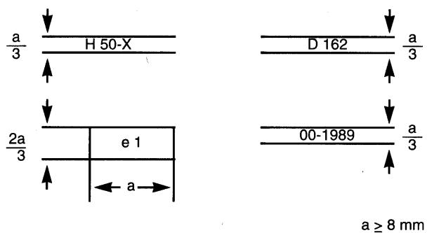
Η διάταξη ζεύξης με τη σήμανση έγκρισης ΕΟΚ, που φαίνεται ανωτέρω, είναι ένας μη τυποποιημένος πείρος του πετάλου ζεύξης, κατηγορίας H50-X, με τιμή του D ίση με 162 kN, για την οποία έχει χορηγηθεί έγκριση τύπου κατασκευαστικού στοιχείου ΕΟΚ στην Ομοσπονδιακή Δημοφρακτία της Γερμανίας (el), υπό τον αριθμό 1989. Τα πρώτα δύο ψηφία 00 υποδηλούν ότι το κατασκευαστικό στοιχείο εγκρίθηκε δυνάμει της αρχικής μορφής της παρούσας οδηγίας.
